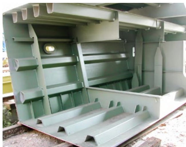
Ryc. 3. Gotowy element mostu wykonany z wykorzystaniem profili trapezowych produkcji firmy SSAB
