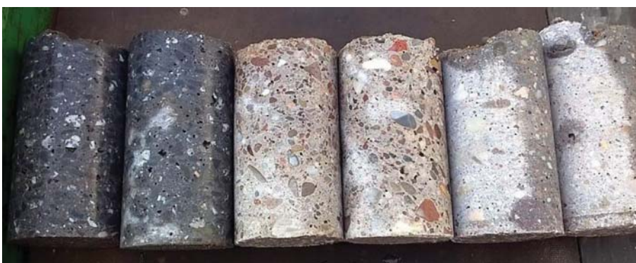
Rys. 4. Widok rdzeni betonowych odwierconych z płyt wylewanych na mokro
