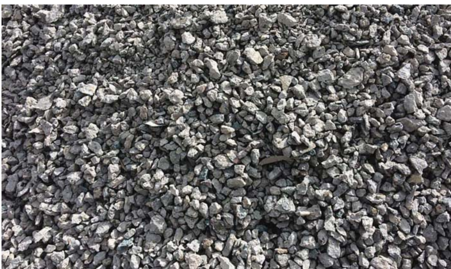
Rys. 3. Recyklowane kruszywo betonowe uzyskane po przekruszeniu płyt
