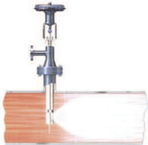
Rys. 4. Schładzacz pary firmy Keystone-Yarway zamocowany na rurociągu parowym [7]
