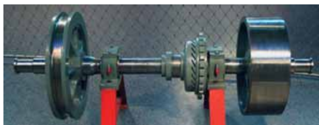
Zestaw kołowy systemu Abty – lewe koło ma obustronne obrzeża, a prawe nie ma obrzeży wcale, a dodatkowo, ma zwiększoną szerokość dla zapewnienia swobodnego przejazdu przez zwrotnicę (28.09.2009 r.) Fot. Brian Snelson
