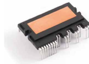
Rys. 5. Widok zintegrowanego stopnia mocy [15]
