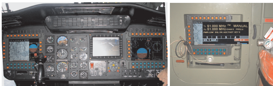
Rys. 2. Widok kabiny śmigłowca W-3PL „Głuszc” z elementami zintegrowanego systemu awionicznego (po prawej monitor w kabine pasażerskiej)
