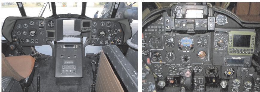
Rys. 1. Widok kabiny z elementami zintegrowanego systemu łączności na śmigłowcach Mi-17/Mi-24
