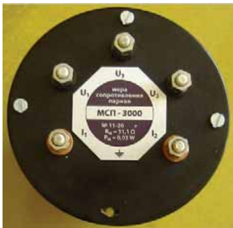
Rys. 7. Płyta zaciskowa podwójnego rezystora wzorcowego
