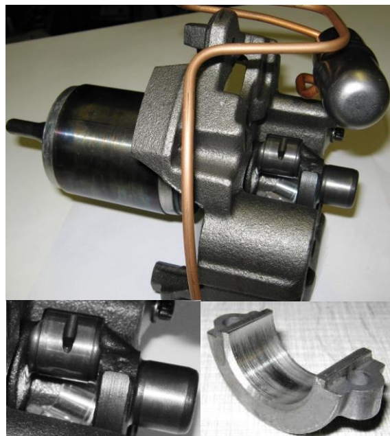
Rys. 2. Sprężarka używana do testów wraz z węzłem ślizgowym z panewką
