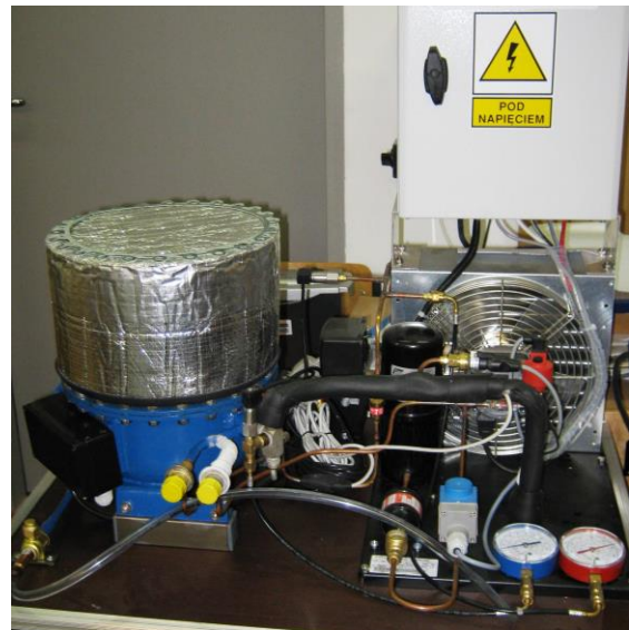
Rys. 1. Stanowisko do badania procesów zużycia sprężarek chłodniczych
