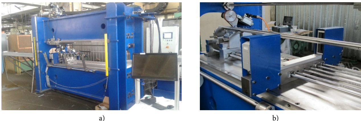
Rys. 4. Urządzenie do prostowania smukłych wyrobów drążonych (a), widok na mikrometr bezstykowy (b) Fig. 4. Machine for straightening slender, hollow products (a), view of contactless micrometer (b)
