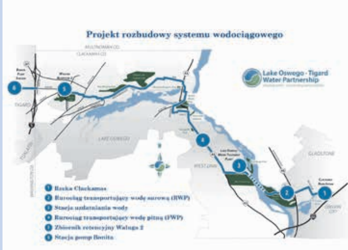
Ryc. 2. Plan rozbudowy systemu wodociągowego, linią przerywaną oznaczono odcinek przebiegający pod rzeką Willamette, wykonany metodą HDD [3]
