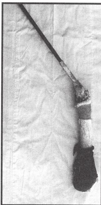
RYS. 1. Usunięta proteza z popękany trzpieniem. Zauważ prawidłowo zużyty gumowy bucik.
