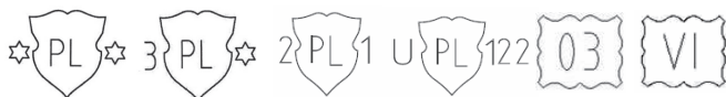
Rys. 1 Wzory cech legalizacji stosowanych przez (kolejno od lewej): Główny Urząd Miar, urzędy okręgowe, obwodowe, podmioty upoważnione oraz wzór cechy rocznej i cechy miesięcznej [2]
