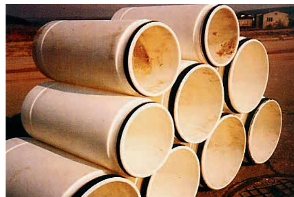
Ryc. 1. Krótkie moduły rur PE-HD firmy KWH Pipe, sprowadzone do Polski z Finlandii w 1991 r., fot. A. Kuliczkowski
