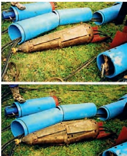
Ryc. 2. Krótkie moduły rur PE-MD wykonane w 1993 r. przez firmę RenoRurCentrum Sp. z o.o. z długich odcinków rur firmy Wavin i uszczelek firmy Stomil Sanok z głowicą hydrauliczną niszczącą stary kanał przed i po jej powiększeniu się, fot. A. Kuliczkowski
