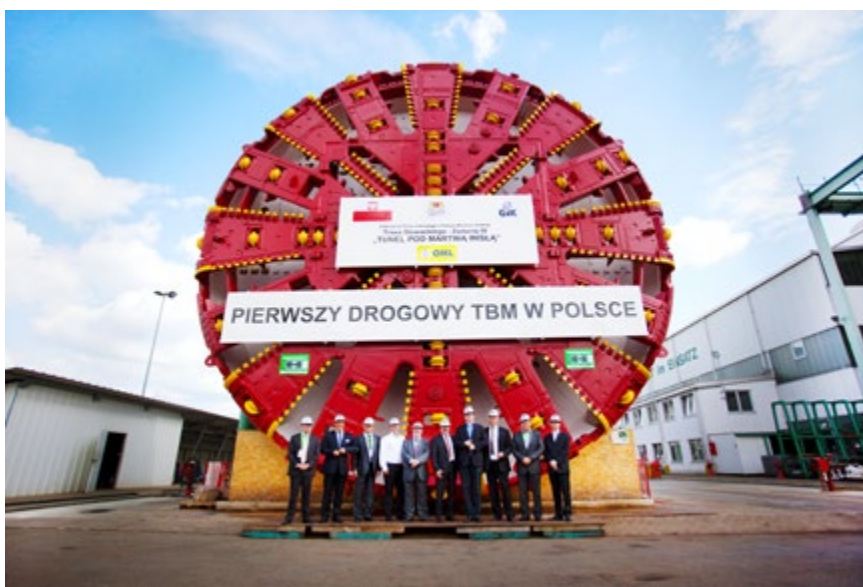
Tarcza maszyny TBM, fot. Gdańskie Inwestycje Komunalne Sp. z o.o.
