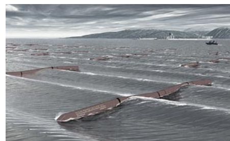
Rys. 2. System Pelamis (wąż morski) [15]
