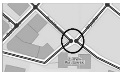
Rys. 4. Pokrywające się węzły, brak połączenia
