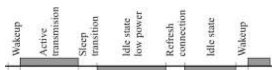
Rys. 7. Aktywność magistrali przy zastosowaniu standardu IEEE 802.3az
