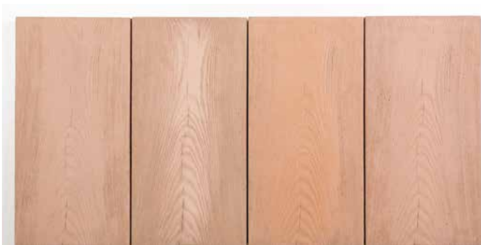
Fot. 9. Wpływ współczynnika wodno-cementowego na wybarwienie betonu – pigment brązowy SB-007. Od lewej: w/c = 0,65, w/c = 0,55, w/c = 0,45, w/c = 0,35
