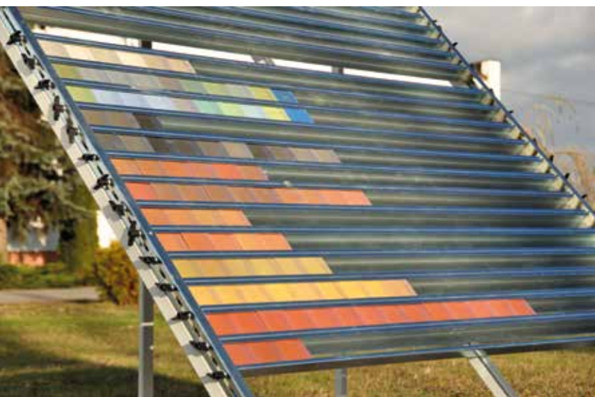
Fot. 2. Badania starzeniowe pigmentów – barwione elementy wystawione na ekspozycję południową – stelaż nachylony pod kątem 45 stopni
