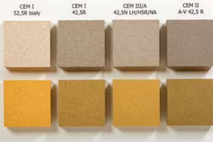
Fot. 6. Wpływ koloru cementu na wybarwienie betonu. Rząd górny: próbki wzorcowe bez pigmentu. Rząd dolny od lewej: pigment żółty SY-020 6,0% m.c. CEM I 52,5R biały, CEM I 42,5R, CEM III/A 42,5N, CEM II A-V 42,5R
