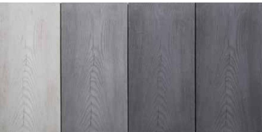
Fot. 7a. Wpływ dozowania pigmentu antracytowego SD-950 na wybarwienie betonu. Od lewej: 1% m.c., 4% m.c., 8% m.c., 12% m.c.
