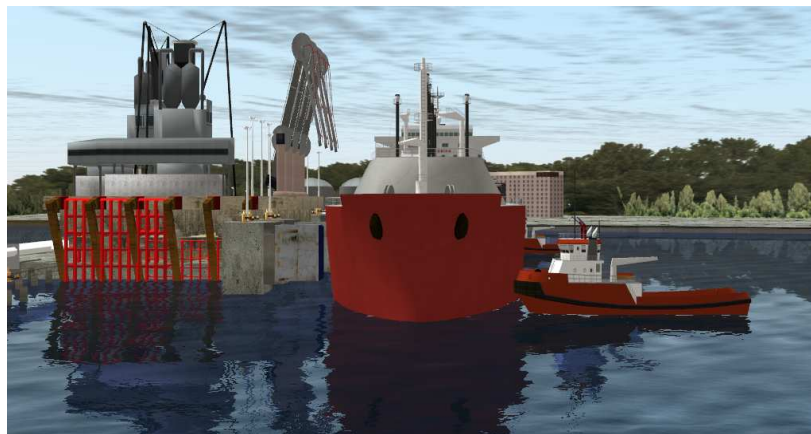
Rys. 6. Asysta holowników dopychających przy terminalu LNG w gazoporcie w Świnoujściu Źródło: Symulator Centrum Inżynierii Ruchu Morskiego, AM w Szczecinie
