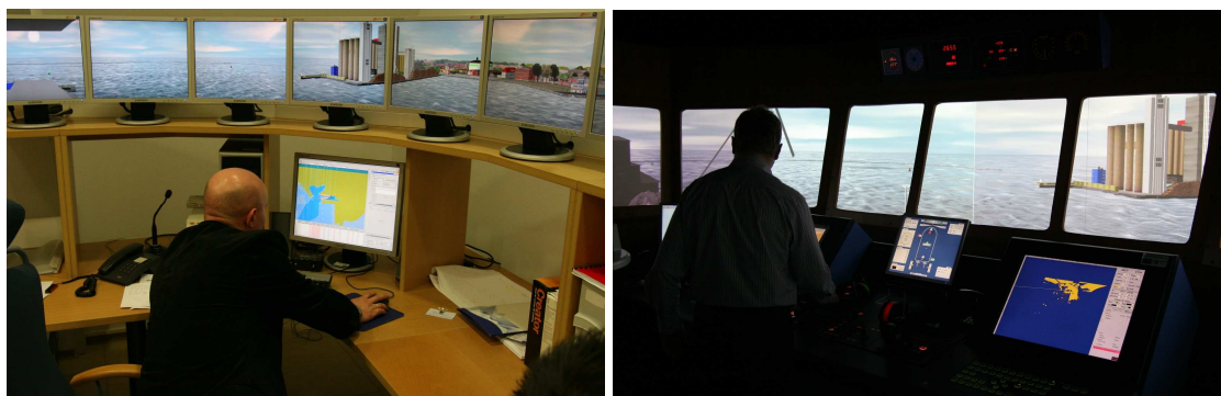
Rys. 7. Stanowisko instruktorskie i mostek nawigacyjny w symulatorze nawigacyjno-manewrowym Źródło: Symulator Centrum Inżynierii Ruchu Morskiego, AM w Szczecinie
