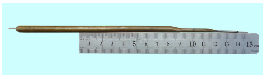
Rys. 3.5. Sonda do pomiaru ciśnienia spiętrzenia
