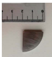
Rys. 1 Próbka ze stopu Ti13Nb13Zr po szlifowaniu Źródło: Archiwum własne.
