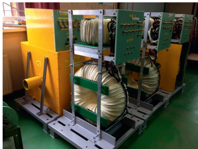
Fot. 1. Przekładniki typu PPZw-30, widok ogólny
