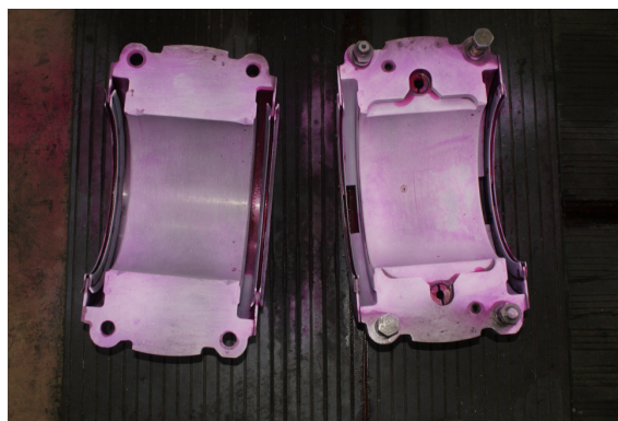
Rys. 4. Panewki generatora pokryte penetranem barwnym
