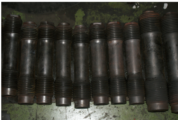
Rys. 8. Śruby dwustronne (szpilki) pokryte penetrantem fluorescencyjnym
