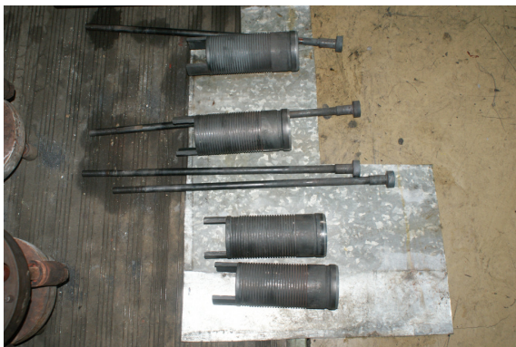
Rys. 7. Zawory grzybków regulacyjnych pokryte penetrantem fluorescencyjnym
