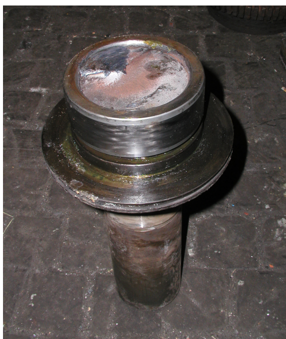
Rys. 2. Widok urwanego wału
