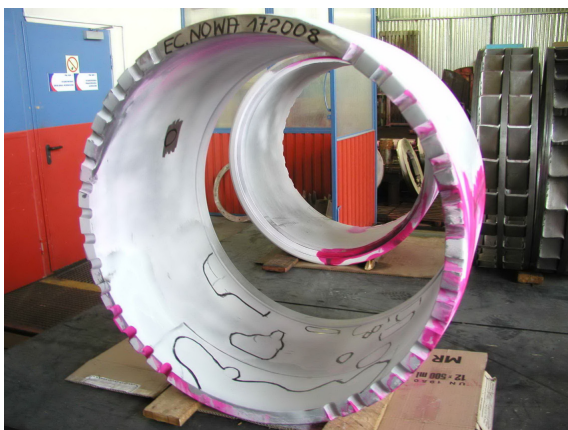
Rys. 9. Widoczne pęknięcia na powierzchni wewnętrznej kołpaka podczas badań penetracyjnych
