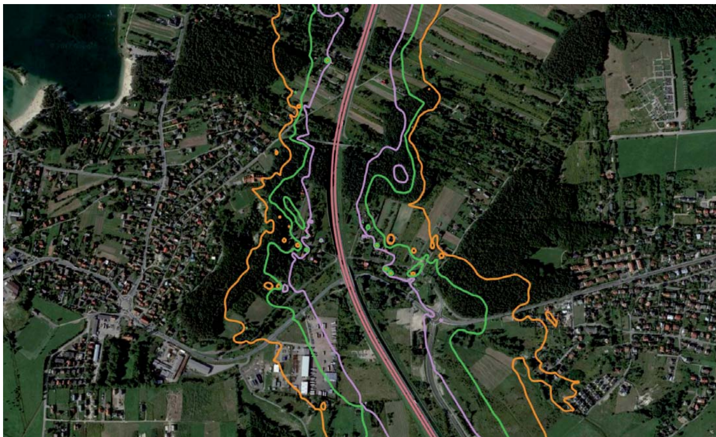
Rys. 5. Zasięg prognozowanych izol linii 56 dB w nocy dla wartości średniej – kolor zielony, minimalnej – kolor fioletowy i maksymalnej – kolor pomarańczowy
