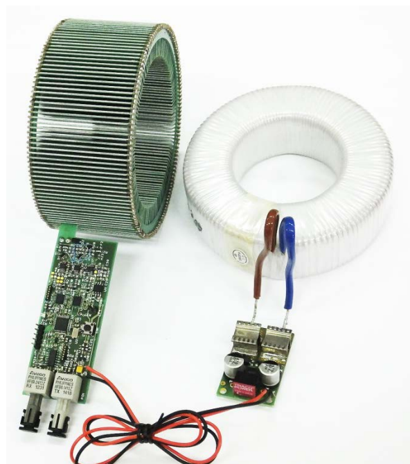
Rys. 2. Widok ISP w wersji z zasilaniem autonomicznym
