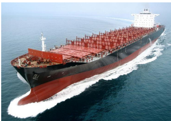
Rys. 2. Statek typu Panamax – kontenerowiec charakteryzujący się dużą szybkością, średniej wielkości zanurzeniem i relatywnie wysoko załadowanym pokładem [9]
