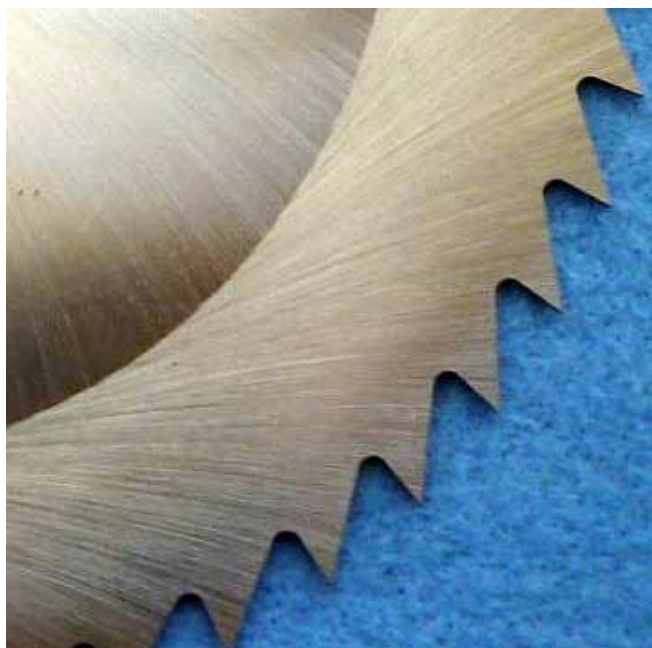
Rys. 15. Nóż tarczowy stosowany do cięcia produktów mrożonych.
