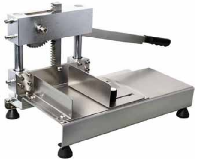
Rys. 4. Gilotyna do mrożonego surowca. Fig. 4. Guillotine for frozen raw material.
