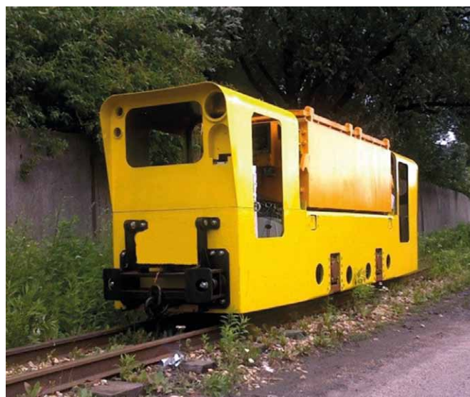
Rys. 1. Górnicza lokomotywa akumulatorowa Lda-12K-EMA
