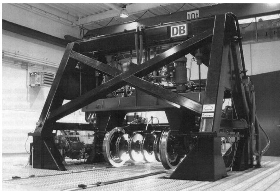
Rys. 13. Stanowisko DB AG do badania oddziaływania zestaw kołowy/tor w Kirchmöser
