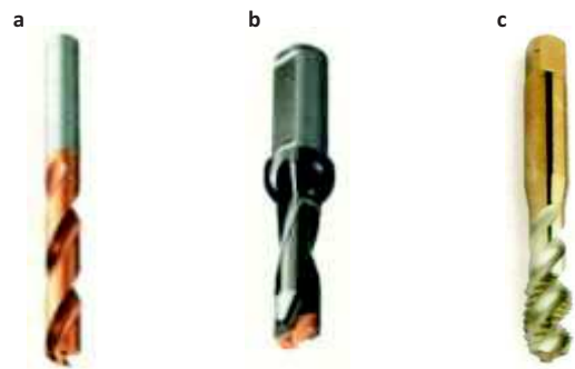
Rys. 1. Narzędzia obrotowe z powłokami przeciwtarciowymi: a) monolityczne wiertło kręte, b) wiertło z wymiennymi ostrzami, c) gwintownik z rowkiem śrubowym [7]
