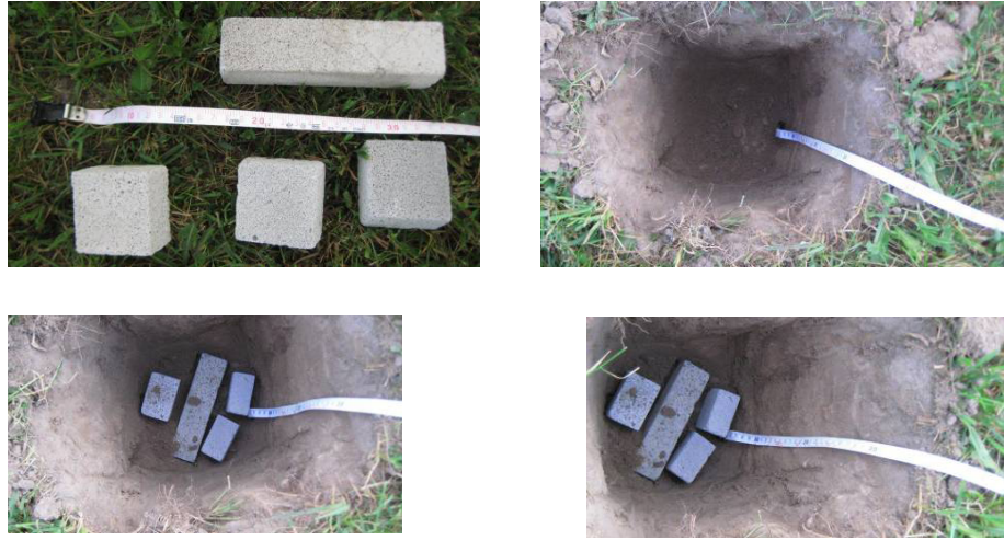
Rys. 5. Ocena hydroizolacyjności pianobetonu w warunkach in-situ Fig. 5. Evaluation of hydro-insulation of the foamed concrete in the in situ state
