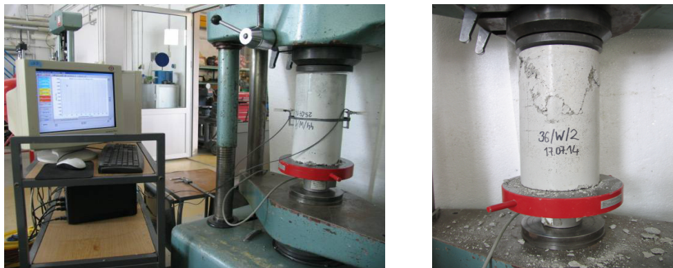
Rys. 6. Badania próbek pianobetonu: a) i b) wyniki testów bezpośredniego ścinania próbek GeoPBG D5, c) i d) wyznaczenie modułu odkształcenia w próbie jednoosiowego ściskania (próbka nr 36)
