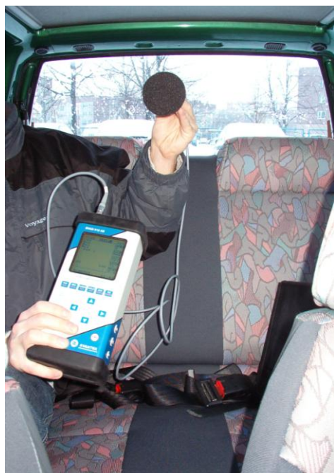
Rys. 1. Miejsca pomiarów hałasu wewnątrz samochodu osobowego, pomiar na miejscu: (a) kierowcy, (b) pasażera
