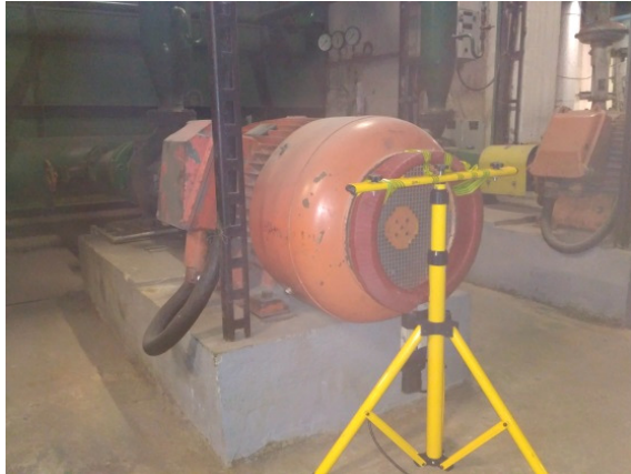
Rys. 1. Sposób pomiaru strumienia poosiowego na stanowisku pracy – cewka na statywie
