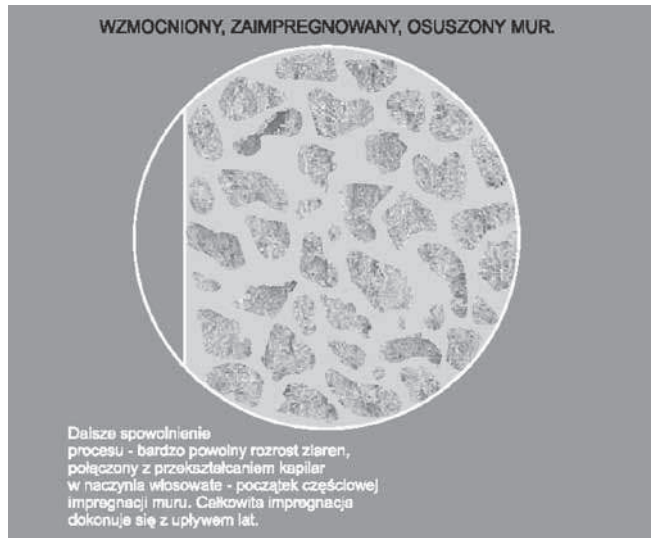
Rys. 9. Schemat muru po zadziałaniu Hermonu I, Hermonu II, Hermonu III i Hermonu IV; koniec procesu osuszania, odgrzybiania i hydrofobizacji muru, a w konsekwencji jego odbudowy (opracowanie własne)
