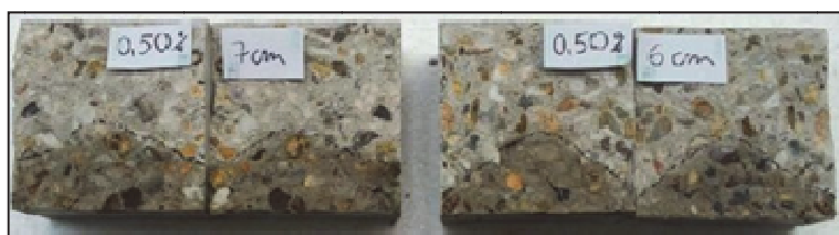
Rys. 6. Wynik badania wodoprzepuszczalności – próbki z domieszką kationowego środka do hydrofobizacji
