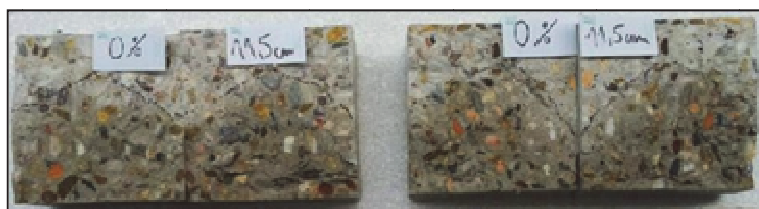
Rys. 5. Wynik badania wodoprzepuszczalności – próbki referencyjne
