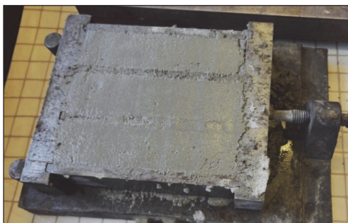
Rys. 2. Formowanie beleczek cementowych
