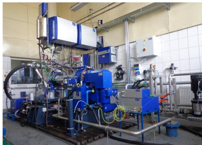
Rys. 1. Schemat stanowiska badawczego wyposażonego w silnik AVL serii 5402
