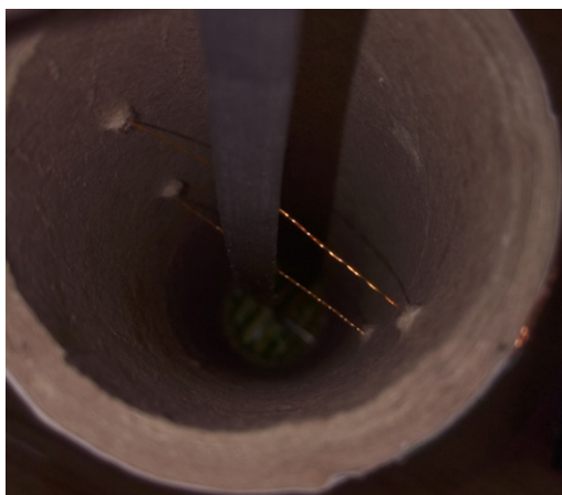
Rys. 3. Czujnik – skręcony emaliowany drut w metalowej osłonce
