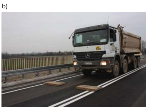
Fot. 1. Przejazd samochodu w czasie badań dynamicznych: a) po równej nawierzchni, b) przez próg
