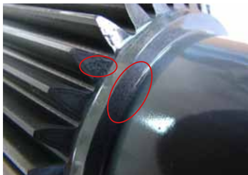
Rys. 1. Nawęglenia w miejscach niedopuszczalnych
