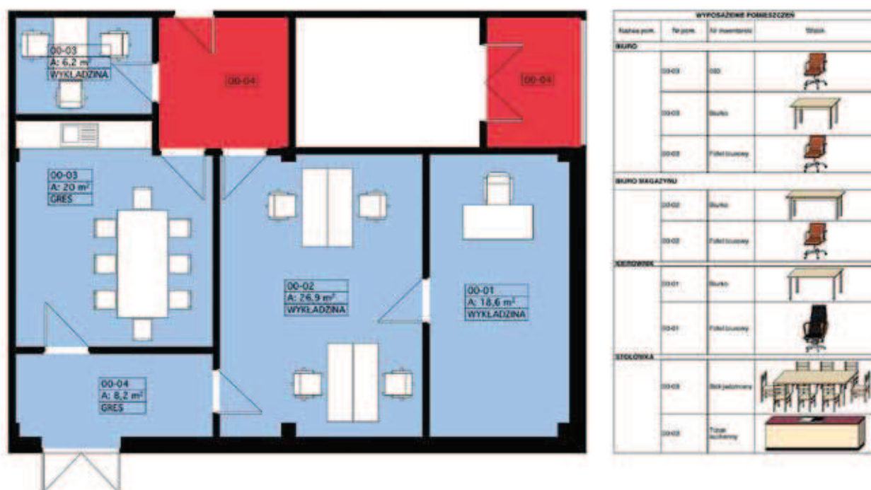
Rys. 4. Przykład zarządzania obiektem – zestawienie wyposażenia dla konkretnych pomieszczeń [2]
