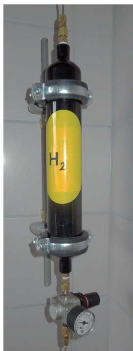
Rysunek 5 Zbiornik buforowy i regulator ciśnienia toru wodorowego
