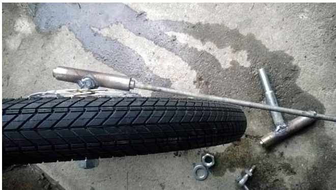
Rys. 6. Prototyp zwrotnicy, widoczny dodatni promień zataczania
