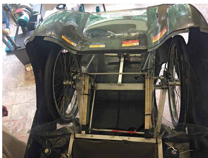
Rys. 9. Układ kierowniczy bolidu SAW na rok 2017
