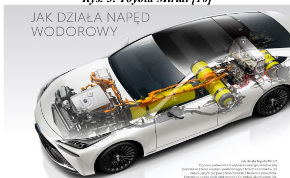
Rys. 3b. Napęd wodorowy w samochodzie Toyota Mirai [10]
