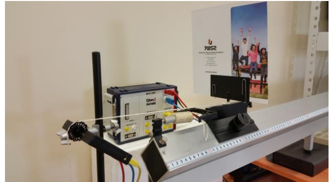
Rys. 6. Tor powietrzny z wózkiem i bramką świetlną. Widoczna konsola pomiarowa Cobra3
