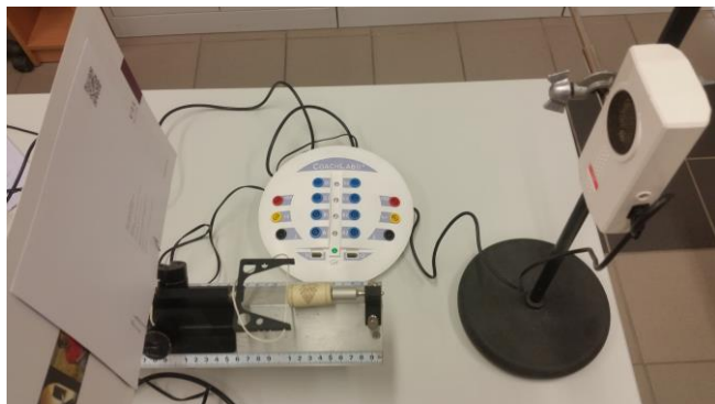
Rys. 9. Tor powietrzny z wózkiem i ultradźwiękowym czujnikiem położenia (po prawej stronie). Widoczna konsola CoachLabII+ umożliwiła sterowanie pomiarem, akwizycję danych pomiarowych, wizualizację wyników pomiarów oraz ich analizę [18].
