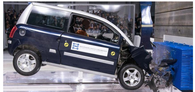
Rys. 1. Eksperyment zderzeniowy przeprowadzony według standardów EURO NCAP na pojeździe kategorii L7e [13]
