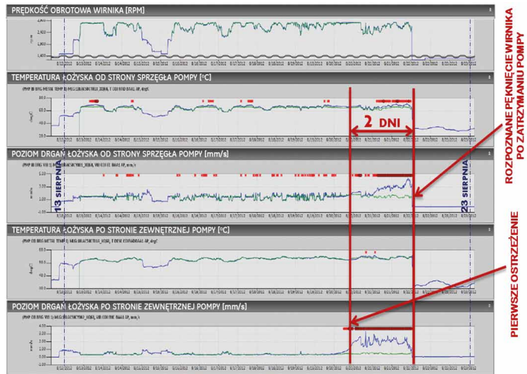
Rys. 15. Rozpoznanie anomalii ST pompy
