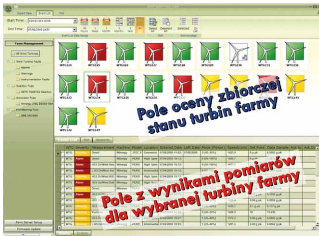
Rys. 8. Przykład ekranu systemu nadzoru stanu technicznego farmy wiatrowej dla systemu wykorzystującego monitory ADAPT
