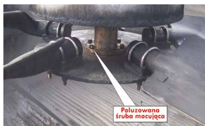
Rys. 14. Wirnik wentylatora ze wskazaną poluzowaną śrubą mocującą na sprzęgle
