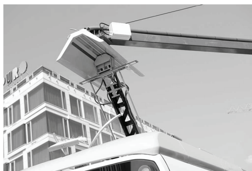
Rys. 2. Konstrukcje ładowarek pantografowych: a) pantograf odwrócony [14], b) pantograf umieszczony na dachu autobusu [13]
