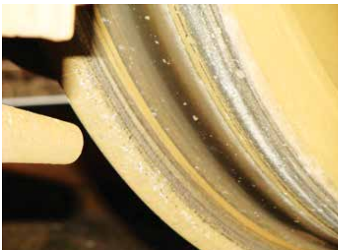
Fot. 1. Stan powierzchni toczonej koła z widocznymi „oblepami”
