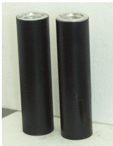
Rys. 1. Pojemniki zaelaborowane dymotwórczą mieszaniną pirotechniczną, stanowiące zasadnicze moduły wysokoenergetyczne 98 mm pocisków moździerzowych
