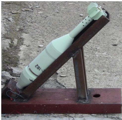
Rys. 2. Poligonowe stanowisko badawcze przygotowane do odpalenia ładunku rozcalającego 98 mm dymnego pocisku moździerzowego pozbawionego ładunku zapłonowego z prochu czarnego, co uniemożliwiało zainicjowanie zapłonu, a następnie palenia (dymienia) ładunku dymotwórczego
