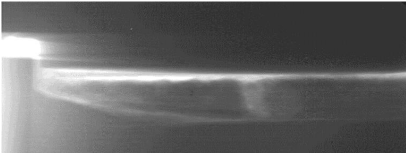
Rys. 5. Powiększony fragment rentgenogramu RTR dennej części pojemnika mieszczącej ładunek dymotwórczy oraz jego ostatniej zaprasowanej warstwy dymotwórczej po badaniach poligonowych z widocznym głębokim, poprzecznie usytuowanym względem powierzchni prasowania pęknięciem masy dymotwórczej oraz skruszoną (ząbkowaną) powierzchnią prasowania
