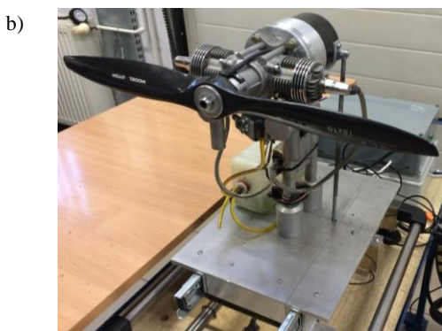
Rys. 3. Silnik RCGF 30 (a) oraz widok silnika na stanowisku badawczym (b) [4]
