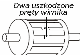
Rys. 9. Wirnik trójfazowego klatkowego silnika indukcyjnego z dwoma uszkodzonymi prętami wirnika
